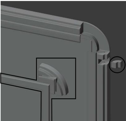
5. Die Türdichtung, sowie beide Verkleidungen des Führungsbolzen auf der zu montierenden Seite entfernen (geklippt & geführt) und Sie auf der gegenüberliegenden Seite wieder anbringen.
